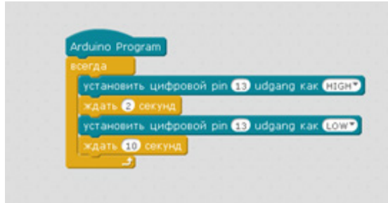
Рисунок 3 – Пример программы движения тележки на 2 секунды движения и на 10 секунд остановки на языке скрэтч
